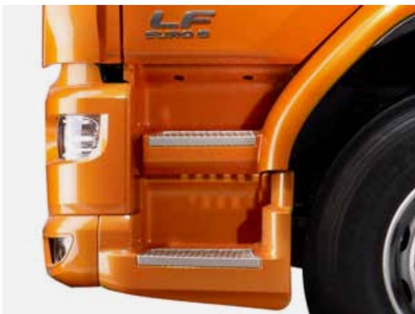
**PRÁCTICO** El transporte de distribución intensivo requiere estar subiendo y bajando de la cabina constantemente. Por esta razón, el nuevo LF ofrece la mejor accesibilidad. Esto se debe a las puertas, que se abren 90 grados, y a una altura desde el suelo muy baja, de 89, 98 o 111 cm según la versión. Los peldaños amplios y antideslizantes, los asideros ubicados estratégicamente y las prácticas luces de cortesía de los peldaños contribuyen a la comodidad absoluta del conductor y el acompañante.
